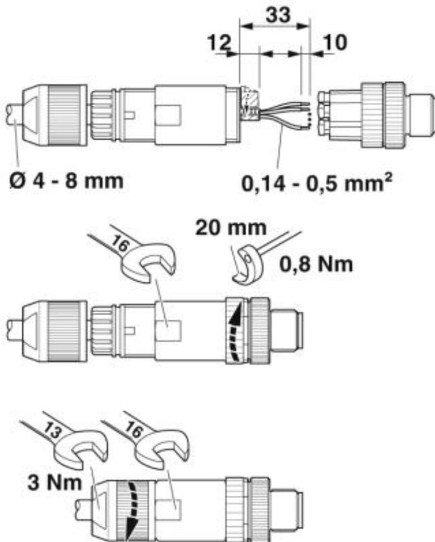
Deslice la tuerca de apriete y la carcasa aérea en el cable, pele el cable, acorte la pantalla, pele los conductores, conecte los conductores, con la carcasa aérea recta tuerza los conductores entre sí, pegue una lámina de pantalla alrededor de la pantalla acortada, si diámetro exterior del cable es  $< 6 \text{ mm}$  pegue una lámina de pantalla adicional alrededor del paquete de conductores, atornille la carcasa aérea con el inserto del conector, apriete la tuerca de apriete.
