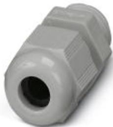
Prensaestopas, material unión atornillada: PA, diámetro exterior del cable 3 mm ... 6,5 mm, apantallamiento: no, rosca de conexión: Pg7, color: gris luminoso RAL 7035
