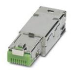
Inserto de contactos, índice de protección: IP20, número de polos: 8, 1 GBit/s, CAT5 (IEC 11801:2002), material: Fundición inyectada de cinc, tipo de conexión: Conexión rápida IDC, sección de conexión: AWG 26-24, salida de cables: recta
