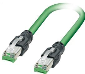
Cable patch, índice de protección: IP20, longitud de cable: 4 m, número de polos: 4, 100 MBit/s, CAT5, material: PA 6.6
