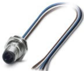
Macho montaje incorp. p/ sensores/actuadores, 5 polos, SPEEDCON M12, codificado A, montaje paredes posteriores/montaje atornillado, rosca M16, con hilo trenzado TPE de 0,5 m, 5 x 0,34 mm<sup>2</sup>
