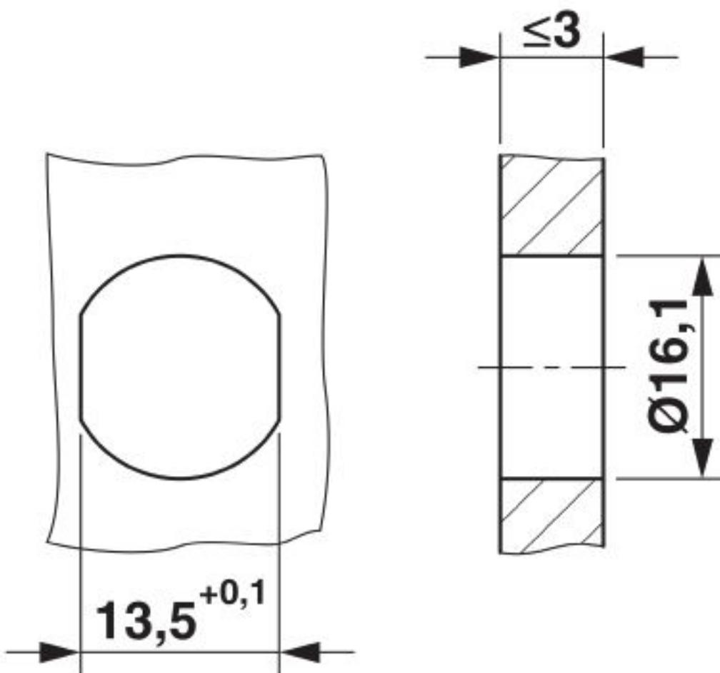
Abertura de carcasa para rosca de fijación M16, pared de montaje con taladro pasante (alternativamente con superficie como protección contra torsión para grosores de pared de montaje  $>2$  mm hasta máx. 4,5 mm)
