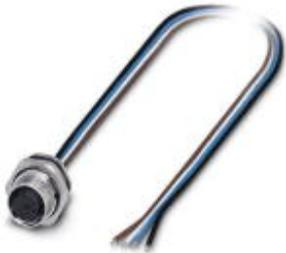
Hembra de montaje incorp. p/ sensores/actuadores, 4 polos, SPEEDCON M12, montaje paredes posteriores/ montaje atornillado, rosca M16, hilo trenzado TPE 0,5 m, 4 x 0.34 mm<sup>2</sup>
