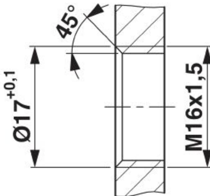
Abertura de carcasa para rosca de fijación M16, pared de montaje con rosca
