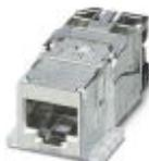
Inserto de hembras RJ45, construcción: RJ45, índice de protección: IP20, número de polos: 8, 10 GBit/s, CAT6<sub>A</sub>, material: Fundición inyectada de cinc, tipo de conexión: Conexión IDC, sección de conexión: AWG 26- 22, Modelo Freenet para empleo con marcos empotrados IP67 y salidas de terminales
