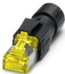
Conector enchufable RJ45, IP20, CAT6<sub>A</sub>, 8 polos, con técnica de conexión rápida QUICKON, para conductores de 1 hilo y 7 hilos AWG 26 ... 24, color: negro
