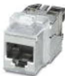
Inserto de hembras RJ45, construcción: RJ45, índice de protección: IP20, número de polos: 8, 10 GBit/s, CAT6<sub>A</sub>, material: Fundición inyectada de cinc, tipo de conexión: Conexión IDC, sección de conexión: AWG 26- 22, Modelo Keystone para uso con marco empotrado IP20 o integración directa en la pared de la carcasa
