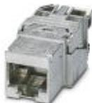
Inserto de hembras RJ45, construcción: RJ45, índice de protección: IP20, número de polos: 8, 10 GBit/s, CAT6<sub>A</sub>, material: Fundición inyectada de cinc, tipo de conexión: Conexión IDC, sección de conexión: AWG 26- 22, salida de cables: recta, versión sin adaptador
