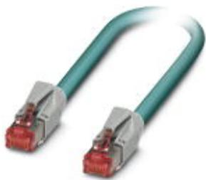
Cable Ethernet confeccionado, CAT6, apantallado, 4 pares, AWG 26 flexible (7 hilos), RAL 5021 (azul agua), conector macho RJ45/IP20 a conector macho RJ45/IP20, Line, longitud 2 m
