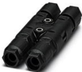
Distribuidor H, Conexión QUICKON, número de polos: 3+PE, 0,5 mm<sup>2</sup> ... 1,5 mm<sup>2</sup>, 690 V, 17,5 A, negro, con tuerca QUICKON, rango de diámetro de cable: 10 mm ... 13 mm, con un perno de cierre
