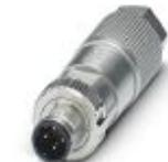
Conectores para datos, Ethernet CAT5 (100 MBit/s), 4-polos, sin halógenos, apantallado, Conector macho recta M12 SPEEDCON, Codificación: D, Conexión por desplaz. de aislamiento, material de moleteado: Fundición inyectada de cinc, niquelada, diámetro exterior del cable 5 mm ... 9,7 mm
