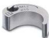
Inserto enchufable para el montaje de cables para sensores/actuadores con conector M12 y de conectores M12 confeccionables, con diámetro del moleteado de 15 mm, para accionamiento hexagonal de 4 mm
