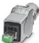
Conector Push-Pull (variante 14), fundición inyectada de cinc, con inserto de conector RJ45 de 8 polos, con técnica de conexión rápida IDC, para cables de 1 y 7 hilos AWG 26 ... 24, para un diámetro de cable de 5,5 mm ... 10 mm
