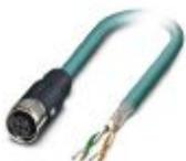
Cable de red, Ethernet CAT5 (100 MBit/s), 4-polos, apantallado, extremo de cable libre, a Hembra recta M12 SPEEDCON / IP67, codificación: D, longitud de cable: Libre introducción (0,2 ...40,0 m)
