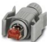
Conector enchufable RJ45, índice de protección: IP67, número de polos: 8, 1 GBit/s, CAT6, material: PA, tipo de conexión: Conexión engastada, sección de conexión: AWG 27- 24, salida de cables: recta, color: gris
