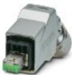
Conector Push-Pull (variante 14), fundición inyectada de cinc, con inserto de conector RJ45 de 8 polos, con técnica de conexión rápida IDC, para cables de 1 y 7 hilos AWG 26 ... 24, para un diámetro de cable de 5,5 mm ... 10 mm
