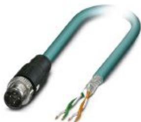
Cable de red, Ethernet CAT5 (100 MBit/s), 4-polos, PUR, azul agua RAL 5021, apantallado, Conector recta M12 SPEEDCON / IP67, codificación: D, a extremo de cable libre, longitud de cable: 2 m
