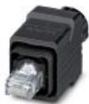
Conector enchufable RJ45, IP67, con bloqueo push-pull, carcasa de plástico, CAT5e, 4 polos, con técnica de conexión rápida QUICKON, para conductores de 1 y 7 hilos AWG 26 ... 22, para diámetros de cable de 5,0 mm ... 8,0 mm
