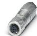
Conectores para datos, Ethernet CAT5 (100 MBit/s), 4-polos, sin halógenos, apantallado, Hembra de conexión recta M12 SPEEDCON, Codificación: D, Conexión por desplaz. de aislamiento, material de moleteado: Fundición inyectada de cinc, niquelada, diámetro exterior del cable 5 mm ... 9,7 mm
