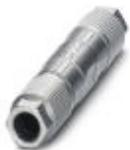
Empalmador de cables, Ethernet CAT5 (100 MBit/s), 4 polos, sin halógenos, apantallado, conexión con borne de conexión por corte de aislamiento, material de la carcasa: fundición inyectada de cinc, niquelado, diámetro exterior del cable 5 mm ... 9,7 mm 9,7 mm
