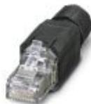
Conector enchufable RJ45, índice de protección: IP20, número de polos: 8, 1 GBit/s, CAT5 (IEC 11801:2002), material: PA, tipo de conexión: Conexión rápida IDC, sección de conexión: AWG 26- 23, salida de cables: recta, color: negro
