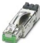
Conector enchufable RJ45, índice de protección: IP20, número de polos: 8, 1 GBit/s, CAT5 (IEC 11801:2002), material: Fundición inyectada de cinc, tipo de conexión: Conexión rápida IDC, sección de conexión: AWG 26- 24, salida de cables: recta, color: verde
