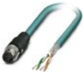
Cable de red, Ethernet CAT5 (100 MBit/s), 4-polos, apantallado, Conector recta M12 SPEEDCON / IP67, codificación: D, a extremo de cable libre, longitud de cable: Libre introducción (0,2 ...40,0 m)
