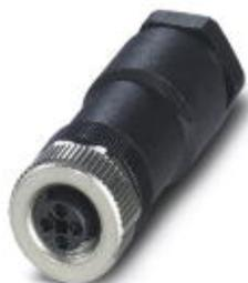
Conector enchufable de potencia, Potencia, 4-polos, sin apantallar, Hembra de conexión recta M12, Codificación: T, Conexión por tornillo, material de moleteado: Fundición inyectada de cinc, niquelada, prensaestopas Pg11, diámetro exterior del cable 8 mm ... 10 mm, para corriente continua hasta 12 A/63 V
