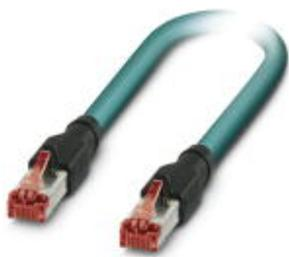
Cable Ethernet confeccionado, apantallado, 4 pares, AWG 26 flexible (7 hilos), RAL 5021 (azul agua), conector macho RJ45/IP20 en conector macho RJ45/IP20, Line, longitud 2 m
