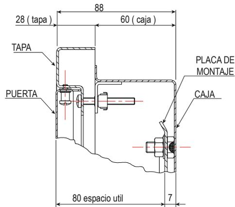
Detalle Caja CTR para paredes de menor espesor
