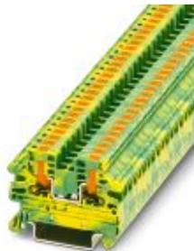
Borne de tierra para carril, tipo de conexión: Conexión push-in, número de conexiones: 2, sección: 0,14 mm<sup>2</sup> - 4 mm<sup>2</sup>, AWG: 26 - 12, anchura: 6,2 mm, altura: 35,3 mm, color: amarillo-verde, clase de montaje: NS 35/7,5, NS 35/15
