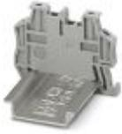
Soporte final de montaje rápido, clase de combustibilidad V0 según UL 94, para carril simétrico NS 35/7,5 o NS 35/15, rotulable con UC-TM 5, UC-TMF 5, KLM 2, KLM3 y KML3L, posibilidad de ubicación para FBS...5, FBS...6, KSS 5, KSS 6, ancho: 5,15 mm, color: gris
