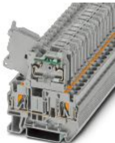
Borna de fusible con palanca, color gris, para cartuchos de fusible G 5 x 20 mm, con LED para 24 V AC/DC
