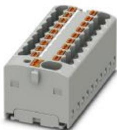
Bloque para distribución, Borne de base con alimentación, tensión nominal: 450 V, corriente nominal: 17,5 A, tipo de conexión: Conexión push-in, Conexión push-in, número de conexiones: 19, sección: 0,14 mm<sup>2</sup> - 2,5 mm<sup>2</sup>, AWG: 26 - 14, anchura: 43,9 mm, altura: 17,7 mm, color: gris, clase de montaje: enclavar en adaptador para carril
