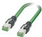
Patch cable, Ethernet (100 MBit/s), PROFINET (100 MBit/s), EtherCAT<sup>®</sup> (100 MBit/s), apantallado, cuadrete en estrella, AWG 22 flexible (7 hilos), verde, conector RJ45/IP20, recto, en conector RJ45/IP20, recto, longitud: 1 m
