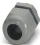
Prensaestopas, material unión atornillada: PA, diámetro exterior del cable 6 mm ... 12 mm, apantallamiento: no, rosca de conexión: M20 x 1,5, color: gris plata RAL 7001
