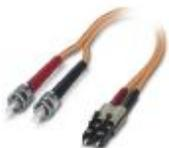
Cable de fibra óptica confeccionado, cable zipcord, fibra de vidrio multimodo 50/125 µm, OM2, conector: B-FOC (ST)/LC, grado de protección: IP20, para la disposición en canaletas de cables o armarios de control
