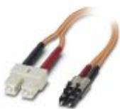
Cable de fibra óptica confeccionado, cable zipcord, fibra de vidrio multimodo 50/125  $\mu\text{m}$ , OM2, conector: SC dúplex/LC, grado de protección: IP20, para la disposición en canaletas de cables o armarios de control
