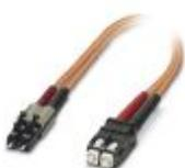
Cable de fibra óptica confeccionado, cable zipcord, fibra de vidrio multimodo 50/125  $\mu\text{m}$ , OM2, conector: LC/SC-RJ, grado de protección: IP20, para la disposición en canaletas de cables o armarios de control
