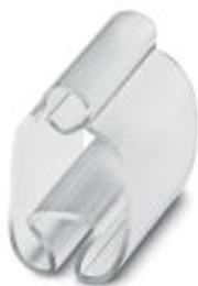
Soporte para señalización de conductores, transparente, sin rotular, clase de montaje: deslizamiento, rango de diámetro de cable: 10 ... 14 mm, superficie útil: 15 x 4 mm
